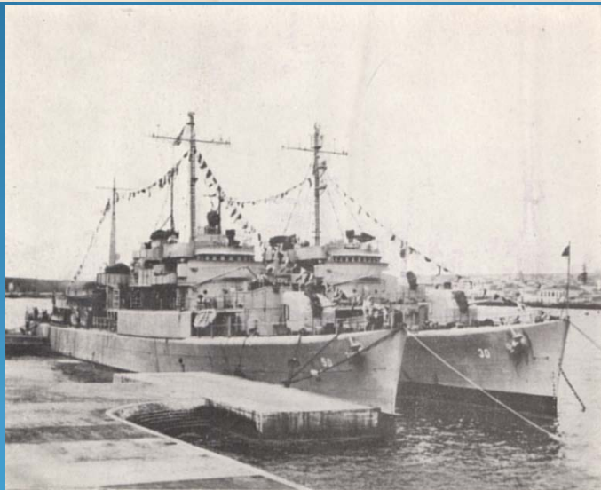
第 10 図 米国水路部の海洋観測船。おそらく世界で最も完備しているもの。 50 U. S. S. Rehoboth (1,766 排水トン、18 kt) 30 U. S. S. Sanpablo (1,766 排水トン、18 kt)
